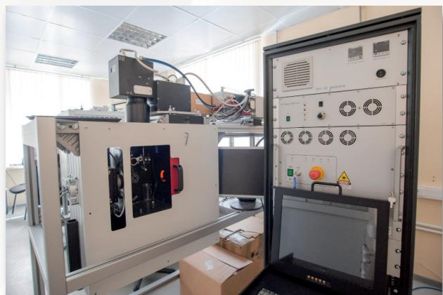
Комплекс лазерной обработки на основе наносекундного лазера Lumera для размерной резки, заточки и изготовления изделий из сверхтвёрдых материалов.
