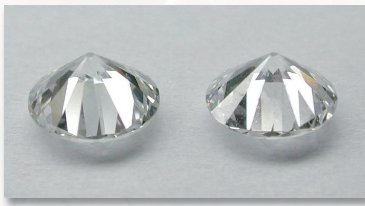
Наковальни из высокочистых монокристаллов алмаза
