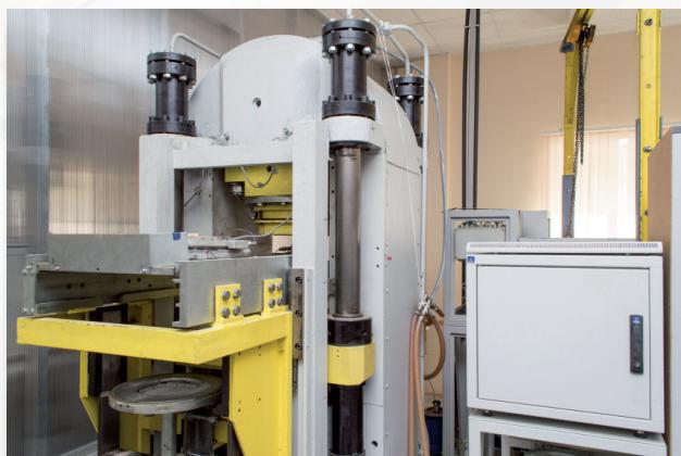
Установка УСУ-01/А для термобарической обработки и синтеза крупных монокристаллов алмаза, сверхтвердых и наноструктурированных материалов и обработка нанокомпозитов.
