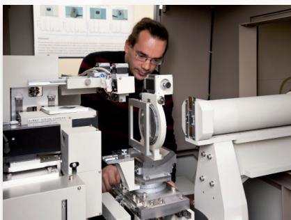
Рентгеновский дифрактометр и топографическая система на основе 18кВт источника с врачающимся анодом.
