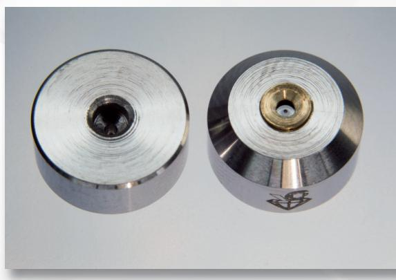
Сопла в сборке с рабочим элементом из монокристалла алмаза
