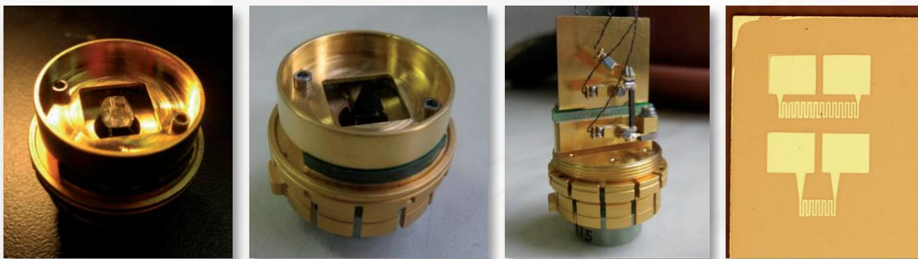
Структуры в держателях для исследования теплоемкости и теплопроводности алмаза
