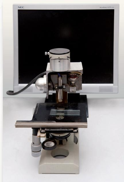
Высокочастотный импульсный акустический микроскоп (диапазон 25÷100 МГц)
