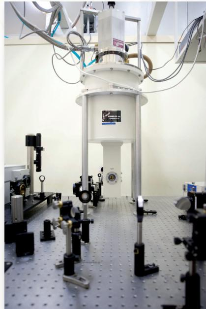
Интегральная оптическая система для оптических спектральных исследований в диапазоне температур от 5 до 800 K.
