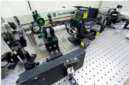
Установка для получения спектров комбинационного рассеяния света (КРС) с системой подавления возбуждающего излучения нотч-фильтрами. Установка создана на базе спектрометра TRIAX series компании HORIBA Jobin Yvon Inc. Источником возбуждающего света служит лазер STABILITE 2017 компании Spectra-Physics.
