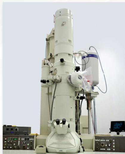
Просвечивающий электронный микроскоп высокого разрешения (до 1,4 Å) JEM-2010, производства фирмы Jeol, Япония.
