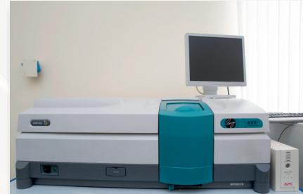
Спектрофотометр Cary используется для решения широкого круга спектрофотометрических задач. Он обеспечивает снятие спектра со скоростью 24000 нм/мин в диапазоне 190-1100 нм с разрешением 1,5 нм. Прибор отличается высокой чувствительностью, стабильностью двухлучевой схемы, широким диапазоном измерений (200-800 нм).
