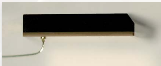
Чувствительные элементы датчиков ионизирующего излучения из монокристаллов CVD на легированных алмазных подложках
