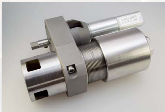
Разработанная и изготовленная в ТИСНУМ сдвиговая алмазная камера высокого давления с электроприводом.
