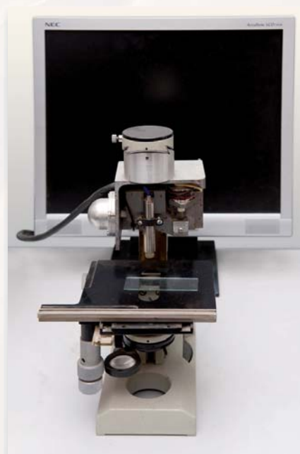
Высокочастотный импульсный акустический микроскоп (диапазон 25÷100 МГц)
