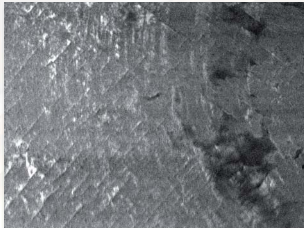
Алмазные наковальни, деформированные при синтезе ультратвердого фуллерита: (а) общий вид наковальни, (б) \times 3000
