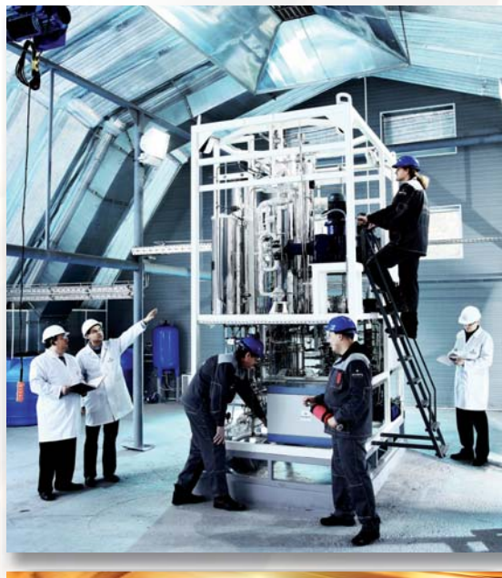
Пилотная установка INFRA GTL, разработанная в отделе новых химических технологий и наноматериалов ТИШУМ по заказу Газпром
