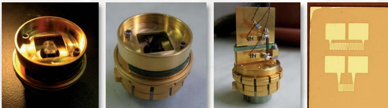
Структуры в держателях для исследования теплоемкости и теплопроводности алмаза
