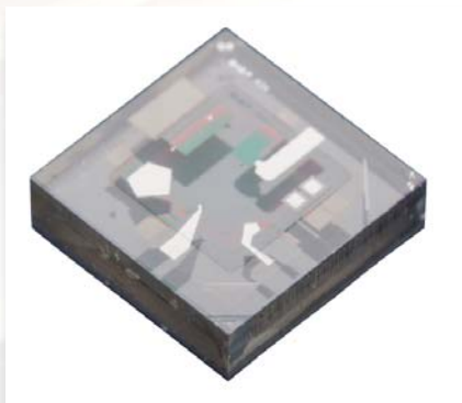
ОАВ-резонаторы на алмазной подложкой со сложной конфигурацией электродов
