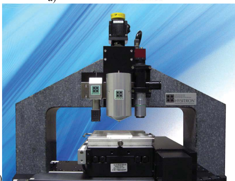
Рисунок 85 – а) Внешний вид прибора в защитном боксе, содержащем виброизолирующую платформу и блок электроники б) Внешний вид станины с базовым трехпластинным емкостным датчиком (three plate transducer), модулем увеличенных нагрузок (3D OmniProbe) и оптическим микроскопом высокого разрешения
