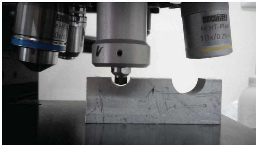
Рисунок 27 – Индентор микротвердомера в полуцилиндрической канавке на поверхности тестового модельного образца
